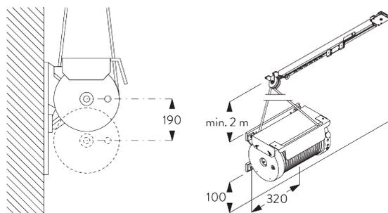
Das Stahlseil wird mit dem Motorgewicht gespannt.
