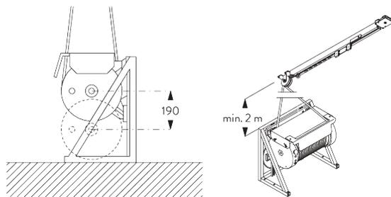
Das Stahlseil wird mit dem Motorgewicht gespannt.
