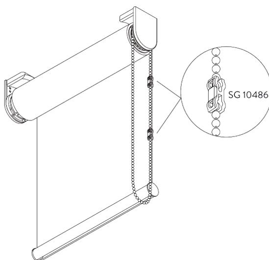
Der Kettenverbinder SG 10486 öffnet sich bei 6 kg Zugbelastung.
