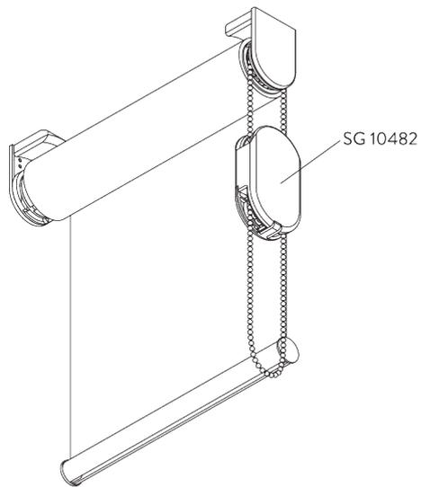
Die Kindersicherung SG 10482 öffnet sich bei 6 kg Zugbelastung.
