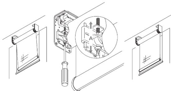
Vertikale Ausrichtung des Stoffes an den Fensterrahmen.
